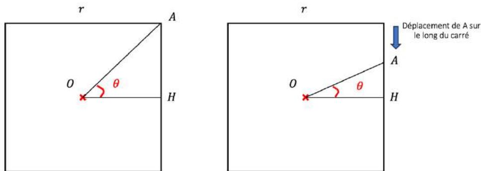
L'intérêt d'avoir un segment perpendiculaire à l'un des côtés du carré est de pouvoir utiliser les lois de trigonométrie puisque les points  $OHA$  forment toujours un triangle rectangle. On peut donc définir la distance  $OA$  en fonction de  $OH$ , qui est une distance fixe, et de l'angle  $\theta$ . On a :
