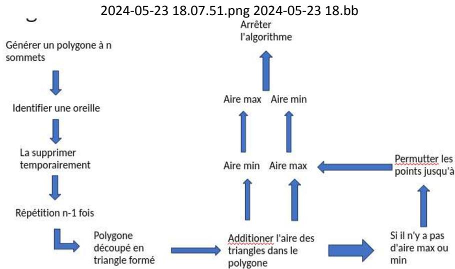
FIGURE 26 – L'algorithme de la triangulation d'aire optimale
