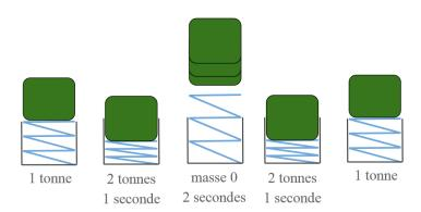
Le camion va devoir passer sur un pont où le poids maximum est de 17 tonnes, pendant 6 secondes.
